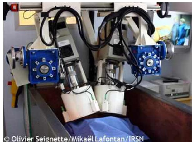
Figure 21 - Mesure anthroporadiométrique pulmonaire à l'aide de détecteurs GeHP
